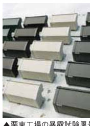
▲東東工場の暴露試験風景（南面35°傾斜）
